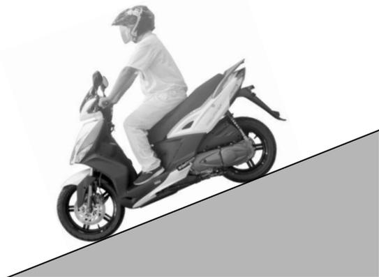
8. Quando descer em uma inclinação acentuada, feche totalmente o acelerador e aplique os freios simultaneamente para diminuir a velocidade da scooter. Evite o uso contínuo dos freios, o que poderia resultar em superaquecimento dos componentes do freio e redução da eficiência de frenagem.
