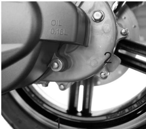
2. Coloque um recipiente adequado (bandeja de drenagem) sob a caixa de transmissão esquerda e remova o parafuso de drenagem de fluido 1.
