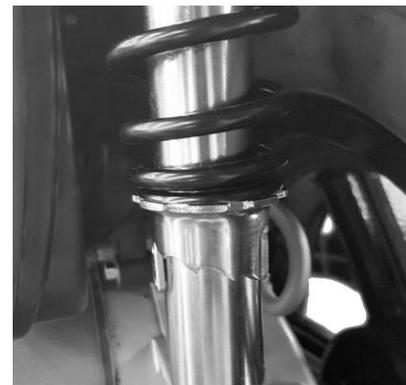
Use uma ferramenta de chave de pinos para ajustar a pré-carga da mola do amortecedor traseiro. Certifique-se de ajustar os dois colares de pré-carga da mola dos amortecedores na mesma configuração.
