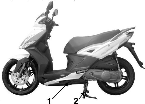
Para estacionar sua scooter no suporte principal, fique do lado esquerdo da scooter e segure o guidão com a mão esquerda, segurando o lado esquerdo do rack traseiro com a mão direita. Pise no pé do suporte principal e puxe para cima e para trás no rack traseiro. Este movimento de elevação permitirá que a scooter balance para trás e para cima no suporte principal.
