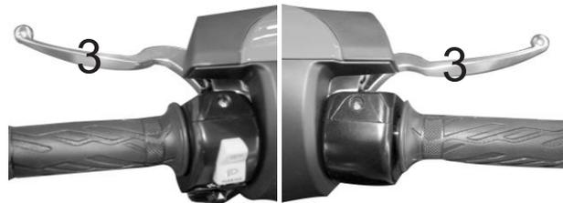
**NOTA:** Diminuir a velocidade da scooter com uma aplicação balanceada das duas alavancas de freio e uma redução do acelerador reduzirá a distância necessária para parar.
