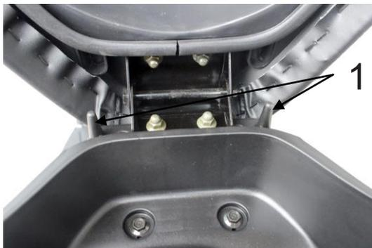
Com o assento para cima, coloque o anel de retenção do capacete no pino. Abaix e pressione o assento para trancá-lo e prenda o capacete no lugar. Para remover o capacete, abra o assento.
