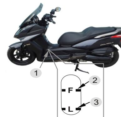
Se o nível de arrefecimento está ABAIXO da marca de nível inferior ③, remova o tapete do chão à esquerda, remova o parafuso da tampa ④, a tampa do tanque de reserva ⑤, e em seguida, a tampa do depósito de reserva ⑥ para adicionar mistura do liquido de arrefecimento até atingir a marca de nível superior ②.
