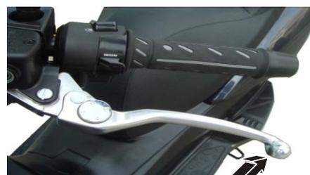
Com o acelerador fechado pressione o botão de partida ① até que o motor entre em funcionamento.
