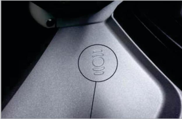
Caso o comando do veículo esteja sem bateria e não permita o funcionamento do veículo à distância, deverá usar o sensor de curta distância. Coloque o comando no símbolo respectivo, à direita dos interruptores centrais, para ligar o veículo. Caso necessite de assistência para trocar as pilhas do seu comando consulte o seu concessionário Kymco.
